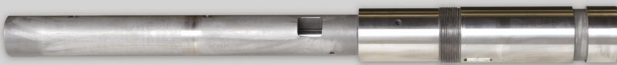
Cylindry podobnie jak ślimaki są elementami, które ulegają zużyciu w wyniku tarcia i korozji, dlatego kluczowym czynnikiem warunkującym trwałość tych elementów, jest dobór odpowiedniego materiału konstrukcyjnego.
